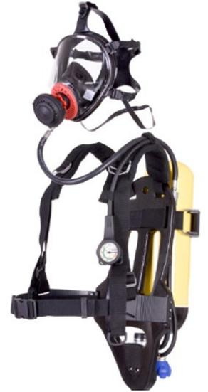
Der Druckminderer hält den Ausgangsdruck während der Entleerung der Flasche konstant und ist an ein leicht ablesbares phosphoreszierendes Manometer angeschlossen. Die Flasche hat einen Druck von 300 bar und ist mit einem Ventil nach EN 144 ausgestattet.
